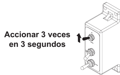
Apagar alimentación eléctrica (se muestra caja de control) FIG. 8-1
