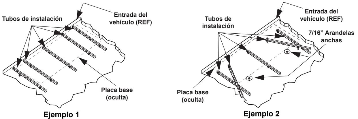
**Asegurando la placa base con los tubos de instalación y placas espaciadoras (Piso del vehículo visto desde abajo)**
