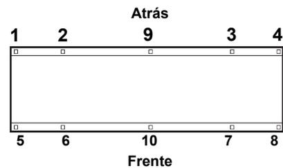
**Patrón de orificios para pernos en la placa base**
