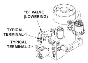
TYPICAL SOLENOID VALVES (GRAVITY DOWN PUMP IS SHOWN) FIG. 72-1
