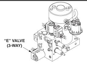
TYPICAL SOLENOID VALVES (POWER DOWN PUMP IS SHOWN) FIG. 67-1
