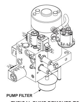
TYPICAL PUMP REMOVED TO CHECK & CLEAN FILTER (POWER DOWN PUMP IS SHOWN) FIG. 62-1
