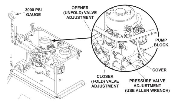
CONNECTING PRESSURE GAUGE -(POWER DOWN DUAL PUMP IS SHOWN) FIG. 70-1
