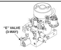
TYPICAL SOLENOID VALVES (POWER DOWN PUMP IS SHOWN) FIG. 69-1
