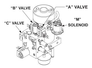
POWER DOWN PUMP/MOTOR FIG. 45-2
