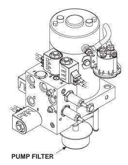
TYPICAL PUMP REMOVED TO CHECK & CLEAN FILTER (POWER DOWN PUMP IS SHOWN) FIG. 60-1
