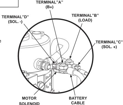
TYPICAL MOTOR SOLENOID ELECTRICAL CONNECTIONS (GRAVITY DOWN PUMP IS SHOWN) FIG. 66-1
