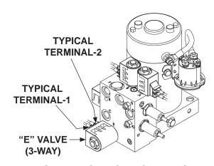
VALVES & ELECTRICAL CONNECTIONS FOR POWER DOWN PUMP FIG. 80-1
