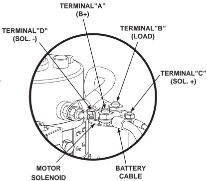
TYPICAL MOTOR SOLENOID ELECTRICAL CONNECTIONS
