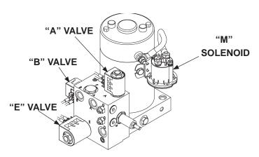
GRAVITY DOWN PUMP/MOTOR FIG. 45-1
