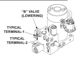
TYPICAL SOLENOID VALVES (GRAVITY DOWN PUMP IS SHOWN) FIG. 74-1
