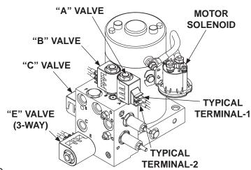
VALVES & ELECTRICAL CONNECTIONS FOR POWER DOWN PUMP FIG. 76-1
