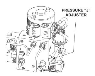
PRESSURE ADJUSTER ON PUMP MANIFOLD FIG. 63-2
