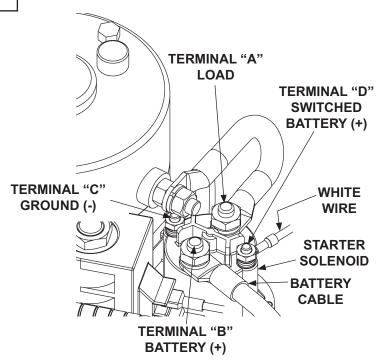
TYPICAL PUMP MOTOR SOLENOID FIG. 57-1
