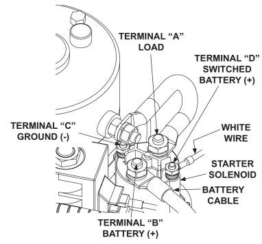
TYPICAL PUMP MOTOR SOLENOID FIG. 52-1
