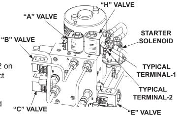
POWER DOWN PUMP/MOTOR VALVES & ELECTRICAL CONNECTIONS FIG. 53-1
