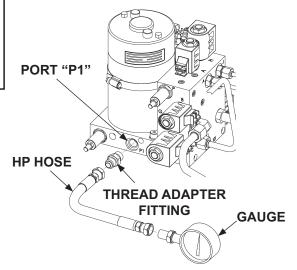
CONNECTING GAUGE TO PORT PLATE ON SINGLE PUMP FIG. 63-1
