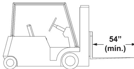
Montacargas con horquillas de 54" de largo
