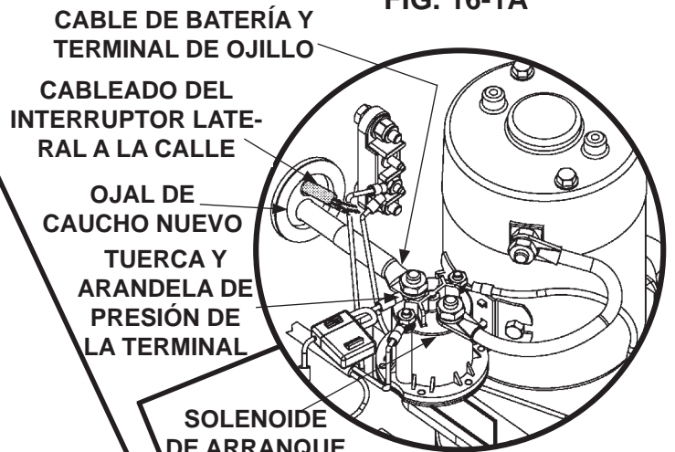
OJAL DE CAUCHO NUEVO FIG. 16-1B
