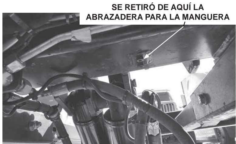
RETIRAR LA ABRAZADERA PARA LA MANGUERA EN EL CILINDRO DE ELEVACIÓN (SE MUESTRA EL CILINDRO DERECHO) FIG. 19-1
