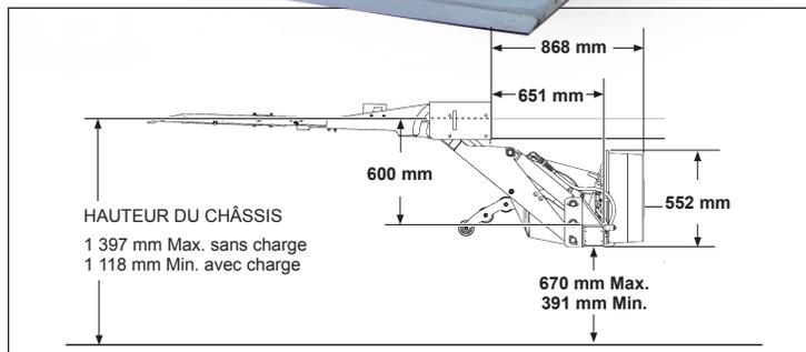
Dimensions du hayon élévateur et exigences de montage des GPTLR-25 et 33
