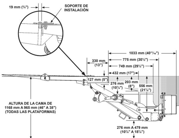
Dimensiones y requisitos de montaje del liftgate
