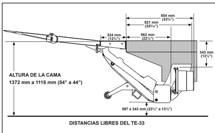
Dimensiones y requisitos de montaje del liftgate
