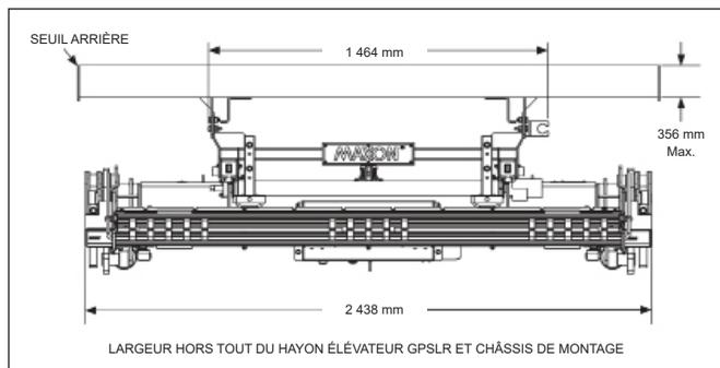
Dimensions du hayon élévateur et exigences de montage du GPSLR
