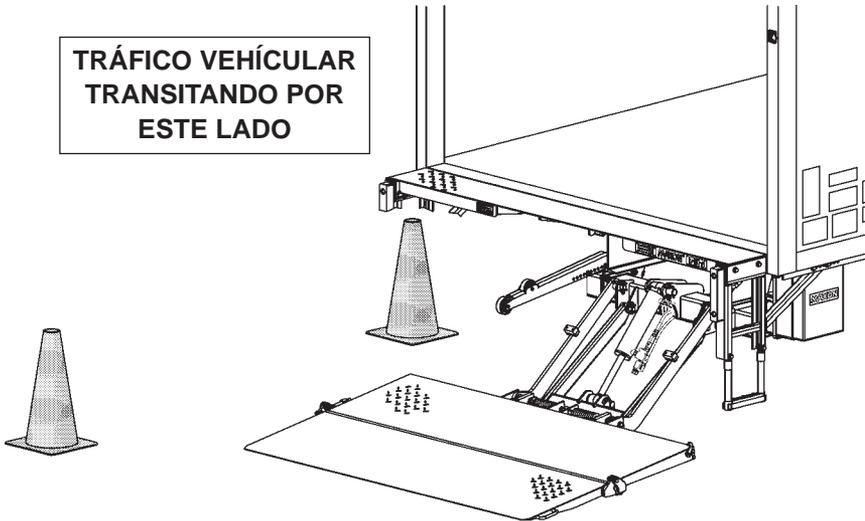
CONOS DE TRÁFICO COLOCADOS JUNTO AL ÁREA DE CARGA
