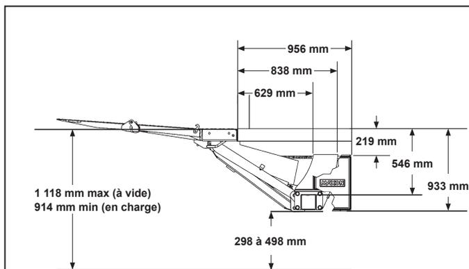
Dimensions et exigences de montage de hayon élévateur TE-25L/TE-30L
