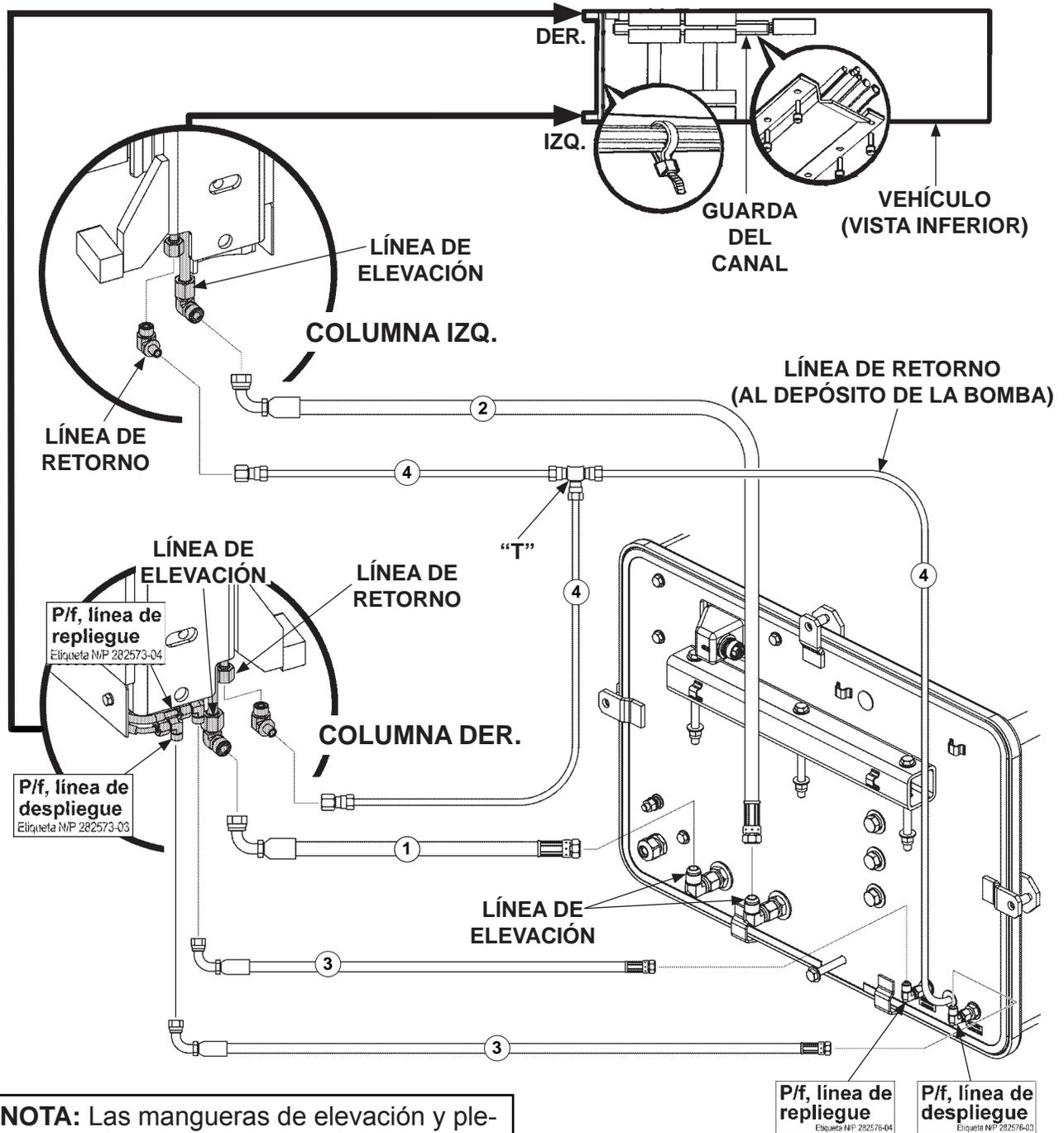
**NOTA:** Las mangueras de elevación y plegables corren hacia arriba de los conectores de la columna hacia el piso del vehículo como se muestra.
