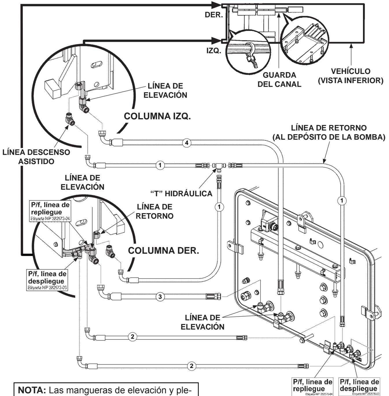
**NOTA:** Las mangueras de elevación y plegables corren hacia arriba de los conectores de la columna hacia el piso del vehículo como se muestra.
