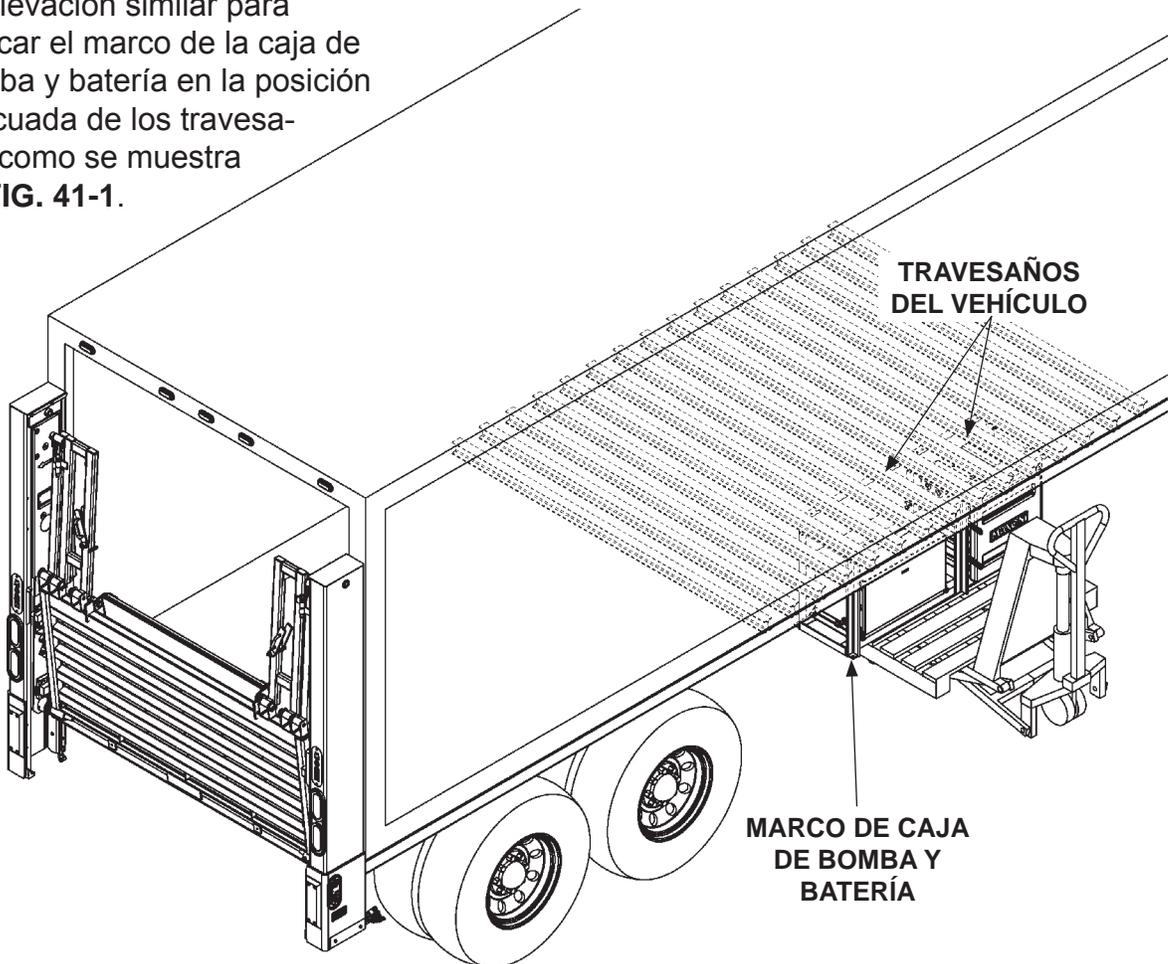
REMOLQUE CON MARCO DE CAJA DE BOMBA Y BATERÍA
