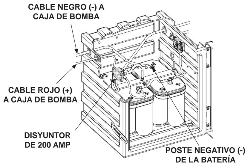
CONEXIONES ELÉCTRICAS EN LA CAJA DE BATERÍA
